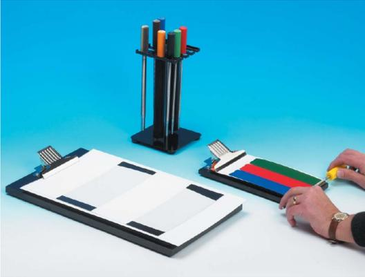
Este equipo permite aplicar de una manera sencilla pero eficaz tintas de flexografía y rotograbado de manera manual. Se puede usar sobre diferentes substratos como cartón, películas plásticas y papel. Se puede aplicar una o más bandas de tinta una al lado de la otra para poder compararlas.
