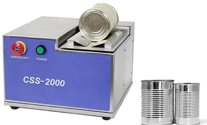
La sierra ha sido diseñada con seguridad. Frente a la hoja de corte hay un sensor de proximidad de modo que si se acerca un material no metálico sobre el sensor la sierra no partirá incluso con el interruptor encendido, de forma que se minimiza los accidentes causados por una operación errónea o descuidada.
