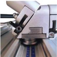
El cabezal de corte se desliza sobre rodamientos.
