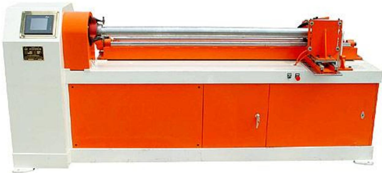
**Para cortar tubos de cartón en forma totalmente automática en dimensiones más pequeñas. La máquina tiene una pantalla en color y el proceso se realiza mediante un PLC Siemens para ajustar automáticamente la distancia de corte de los cuchillos según el largo y la cantidad.**
