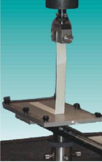
Accesorio para ensayos de despegado en 180° para cintas adhesivas
