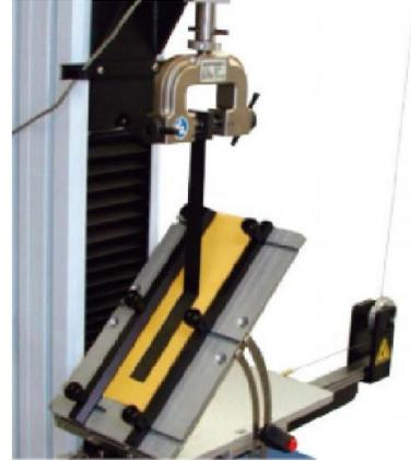
Accesorio para ensayos de penetración de film
