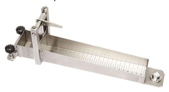
El consistómetro Bostwick mide la distancia dentro de la cual fluye un material según su propio peso durante un determinado intervalo de tiempo para determinar la consistencia. Un canal graduado cada 0,5 cm permite medir el flujo con precisión. Esto permite al usuario predeterminar fórmulas para estandarizar lotes de producción.
