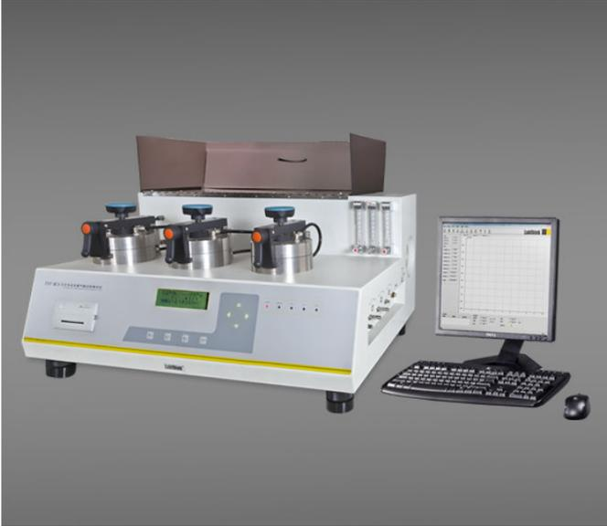
**Método de detección electrolítica para medición de tasa de permeabilidad al vapor de agua en diversos materiales de embalaje como películas plásticas, películas laminadas y otros tipos de materiales de barrera empleados en la industria alimenticia, farmacéutica, etc. El usuario puede controlar y ajustar el índice técnico midiendo la tasa de transmisión de vapor de agua.**
